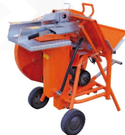
Il banco sega a "V" con piano basculante permette di segare tronchi di svariate dimensioni. La lama in caso di pericolo, grazie ad una scheda elettronica montata sulla scatola motore, può essere bloccata molto velocemente. Per tagliare e spaccare con una sola macchina; è stato ideato questo modello; per coloro che, avendo problemi di spazio, non possono tenere le due macchine separatamente.
